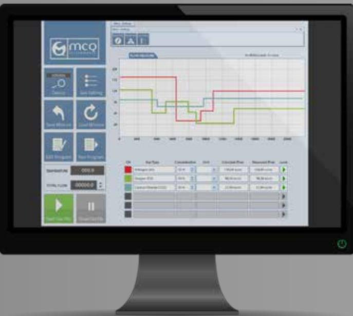
MCQ Mixture Creator ist unsere Mischsoftware, die den direkten Zugriff und die Kontrolle über alle unsere Produkte ermöglicht. Dank einer benutzerfreundlichen Schnittstelle können Sie den Gasmischprozess verwalten, indem Sie direkt auf dem einzelnen Kanal eingreifen, um sowohl die Endmischung als auch Ihre dynamische Verdünnung zu modifizieren und zu steuern.
